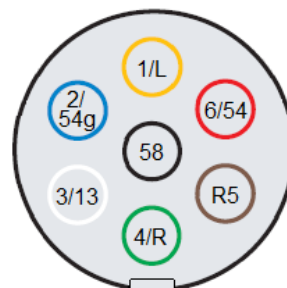
Bild. 51 Anordnung der Kontakte im 7-poligen Stecker
